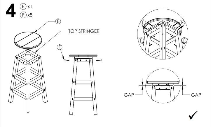
NOTE: THE TOP STRINGER SHOULD BE FLUSH AGAINST THE LIP ON THE SWIVEL MECHANISM AND EVEN ON ALL SIDES.
