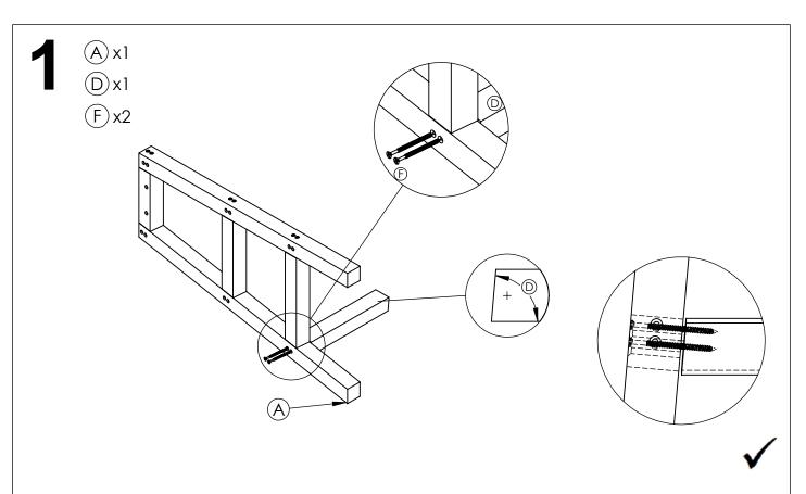
NOTE: MAKE SURE TO ALIGN ALL THE NEW STRINGERS WITH THE STRINGER ON THE LEG-ASSEMBLY
